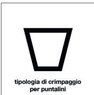
Tipo: GSEA (per terminali, sezione 0,5 - 2,5 mm<sup>2</sup> e per puntalini, sezione 0,25 - 4 mm<sup>2</sup>)
