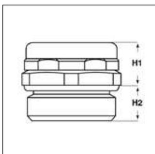
**Materiale:** tappi in ottone nichelato, membrana in PES (Polietersulfone), O-Ring in NBR.
