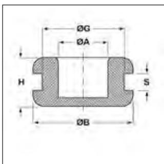
**Materiale:** PVC 9542.**Colore:** nero.**Temperatura d'uso:** -30°C / +70°C**Infiammabilità:** antifiamma UL94-HB.
