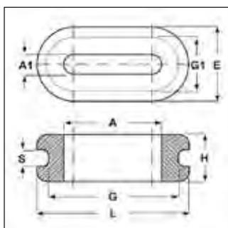
**Materiale:** TPE senza alogeni.**Colore:** nero.**Temperatura d'uso:** -50°C / +125°C**Infiammabilità:** antifiamma UL94-HB.**Caratteristiche:** i passacavi ovali vengono utilizzati per la protezione dei cavi piatti e tondi.
