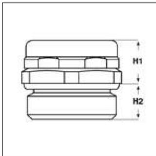
**Materiale:** tappi in ottone nichelato, rete di drenaggio in acciaio inossidabile (1.4301), O-Ring in NBR.
