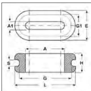
**Materiale:** PVC 9542.**Colore:** nero e grigio.**Temperatura d'uso:** -30°C / +70°C**Infiammabilità:** antifiamma UL94-HB.**Caratteristiche:** i passacavi ovali vengono utilizzati per la protezione dei cavi piatti e tondi.
