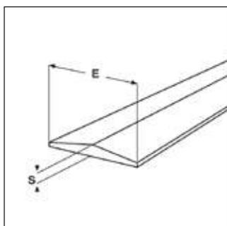
**Materiale:** elastomero di silicone autovulcanizzante di estrema qualità. Possiede una buona rigidità dielettrica, un'ottima elasticità ed una buonissima resistenza all'invecchiamento.
