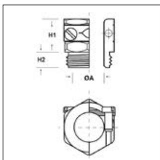
**Materiale:** testa in ottone nichelato, viti in acciaio inox.**Caratteristiche:** testa con morsetto antistrappo ed antitorzione.
