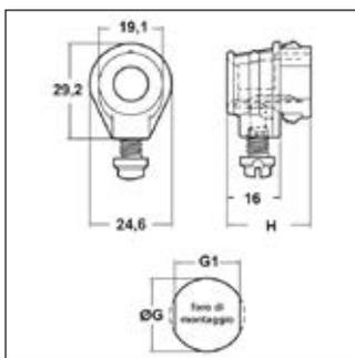
**Materiale:** poliammide 6/6.**Colore:** nero.**Temperatura d'uso:** max +105°C**Infiammabilità:** antifiamma e autoestinguenti UL94-V2.**Caratteristiche:** questi bloccacavi presentano una buona resistenza ai prodotti chimici e buone proprietà elettriche. Offrono una valida protezione elettrica e meccanica ai cavi, assorbendo le forze di trazione, spinta e torsione che possono essere esercitate sui cavi stessi.
