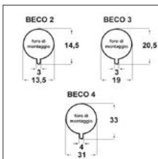
**Materiale:** poliammide 66 rinforzato con fibra di vetro.**Colore:** nero o bianco.**Temperatura d'uso:** max +120°C**Infiammabilità:** antifiamma UL94-HB.**Caratteristiche:** questi bloccacavi sono stati approvati per l'utilizzo in Classe II. Possiedono la filettatura esterna e vengono forniti con nippel per il fissaggio a parete.**Tipo: BECO (con filetto esterno e nippel)**
