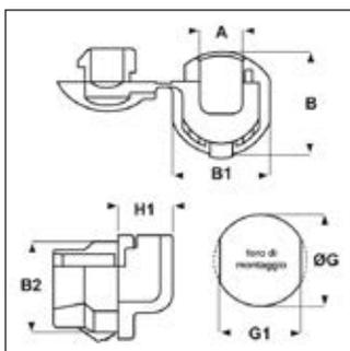
**Materiale:** poliammide 6/6.**Colore:** nero.**Temperatura d'uso:** max +105°C**Infiammabilità:** antifiamma e autoestinguente UL94-V2.**Caratteristiche:** questi bloccacavi presentano una buona resistenza ai prodotti chimici e buone proprietà elettriche. Offrono una valida protezione elettrica e meccanica ai cavi, assorbendo le forze di trazione, spinta e torsione che possono essere esercitate sui cavi stessi.
