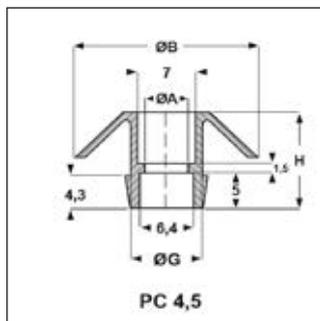
**Materiale:** polietilene per le boccole PC 4,5 e PC 11, polipropilene per le restanti boccole.
