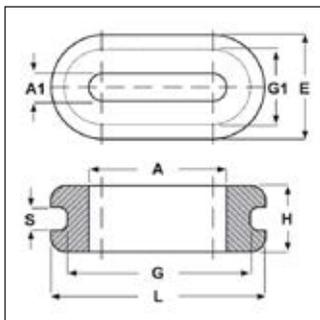
**Materiale:** TPE senza alogeni.**Colore:** nero.**Temperatura d'uso:** -50°C / +125°C**Infiammabilità:** antifiama UL94-HB.**Caratteristiche:** i passacavi ovali vengono utilizzati per la protezione dei cavi piatti e tondi.
