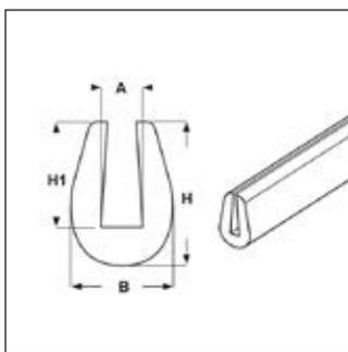
**Materiale:** PVC antifiamma.**Colore:** nero.**Temperatura d'uso:** -20°C / +90°C**Infiammabilità:** antifiamma e autoestinguenta UL94-V2.**Caratteristiche:** il profilato passacavo si applica a mano, senza l'ausilio di alcun attrezzo, e serve per la protezione e l'isolamento dei cavi passanti attraverso i bordi taglienti di lamiere o pareti. È molto flessibile e risulta essere adatto in presenza di fori di grosse dimensioni o con forme irregolari.**Tipo: EX (profilo pieno, per esterni)**
