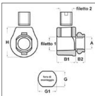
**Materiale:** poliammide 66 rinforzato con fibra di vetro.**Colore:** nero o bianco.**Temperatura d'uso:** max +120°C**Infiammabilità:** antifiamma UL94-HB.**Caratteristiche:** questi bloccacavi possono accogliere cavi con diametro minimo 4,8 mm e massimo 6,5 mm. Sono stati approvati per l'utilizzo in Classe II. Si fissano a scatto.**Su richiesta:** sono disponibili in colore oro.**Tipo: BFS (con innesto a scatto)**
