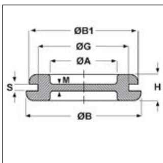
**Materiale:** PVC 9542.**Colore:** nero o grigio RAL 7035.**Temperatura d'uso:** -30°C / +70°C**Infiammabilità:** antifiamma UL94-HB.**Caratteristiche:** in fase di montaggio, la membrana può essere forata secondo il diametro del cavo, assicurando così una buona tenuta alla polvere.
