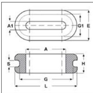
**Materiale:** PVC 9542.**Colore:** nero e grigio.**Temperatura d'uso:** -30°C / +70°C**Infiammabilità:** antifiama UL94-HB.**Caratteristiche:** i passacavi ovali vengono utilizzati per la protezione dei cavi piatti e tondi.
