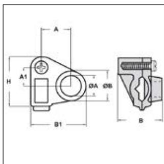
**Materiale:** poliammide 66.**Colore:** nero o bianco.**Temperatura d'uso:** max +105°C**Infiammabilità:** antifiamma e autoestinguenti UL94-V2.**Caratteristiche:** questi bloccacavi vengono fissati a parete per mezzo della vite autofilettante in metallo, fornita separatamente insieme ai bloccacavi.
