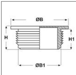
**Materiale:** corpo in Polietilene e membrana in TPE, senza alogeni.
