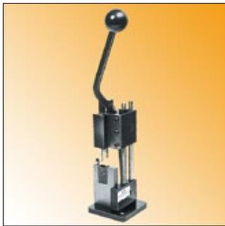
**Caratteristiche:** questi sono gli utensili ideali per preassemblare grandi quantità di bloccacavi tipo "ST" sui cavi e sono molto semplici da utilizzare. Infatti, basta posizionare il bloccacavo sulla matrice, appoggiare il cavo sul bloccacavo, quindi azionare la leva. Il bloccacavo si chiuderà fermamente sul cavo e sarà pronto per essere installato nel foro.
