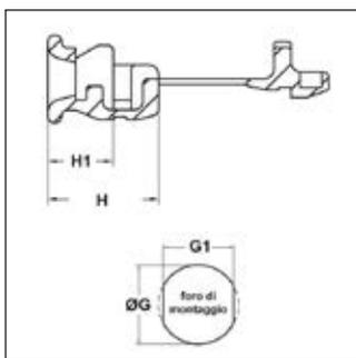
**Materiale:** poliammide 6/6.**Colore:** nero.**Temperatura d'uso:** max +105°C**Infiammabilità:** antifiamma e autoestinguenti UL94-V2.**Caratteristiche:** questi bloccacavi presentano una buona resistenza ai prodotti chimici e buone proprietà elettriche.
