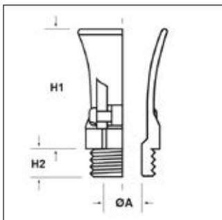
**Materiale:** testa in polica rbonato, viti in acciaio inox.**Colore:** grigio chiaro RAL 7035.**Temperatura d'uso:** -40°C / +135°C**Caratteristiche:** testa a campana in policarbonato con morsetto antistrappo e antitorsione.
