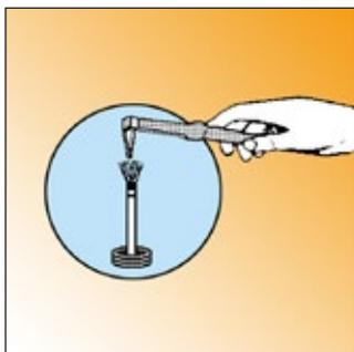
**Caratteristiche:** il lubrificante per manicotti LUB 2 è un liquido speciale, inodore, non tossico, a base di olio di vaselina, che facilita il montaggio dei manicotti mediante l'uso delle nostre pinze a tre becchi. È contenuto in una lattina di 0,25 L sul cui tappo è fissato un pennello utile per la lubrificazione dei becchi delle pinze. Questo prodotto è particolarmente indicato per il montaggio dei manicotti con dimensioni più grandi.
