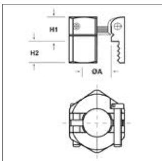
**Materiale:** testa in ottone nichelato, viti in acciaio inox.**Caratteristiche:** testa con bordo arrotondato e con morsetto antistrappo ed antitorsione.
