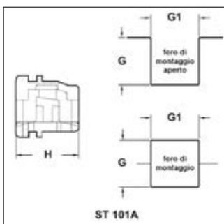
**ST 101A****Materiale:** poliammide 6/6.**Colore:** nero.**Temperatura d'uso:** max +105°C**Infiammabilità:** antifiamma e autoestinguenti UL94-V2.**Caratteristiche:** questi bloccacavi presentano una buona resistenza ai prodotti chimici e buone proprietà elettriche. Offrono una valida protezione elettrica e meccanica ai cavi, assorbendo le forze di trazione, spinta e torsione che possono essere esercitate sui cavi stessi.
