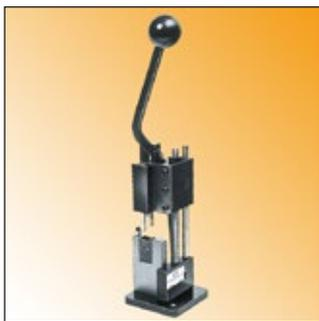
**Caratteristiche:** questi sono gli utensili ideali per preassemblare grandi quantità di bloccacavi tipo "RDD" sui cavi e sono molto semplici da utilizzare. Infatti, basta posizionare il bloccacavo sulla matrice, appoggiare il cavo sul bloccacavo, quindi azionare la leva. Il bloccacavo si chiuderà fermamente sul cavo e sarà pronto per essere installato nel foro.
